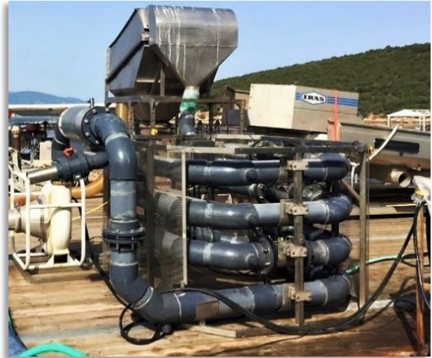
Figuur 8. Potentiële humane bedwelmingsmethode: elektrische bedwelmingsmethode in water (Ace Aquatec, 2019)
